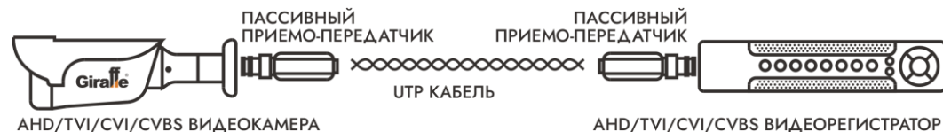
Рис. 1 Схема включения пассивного приемопередатчика.
