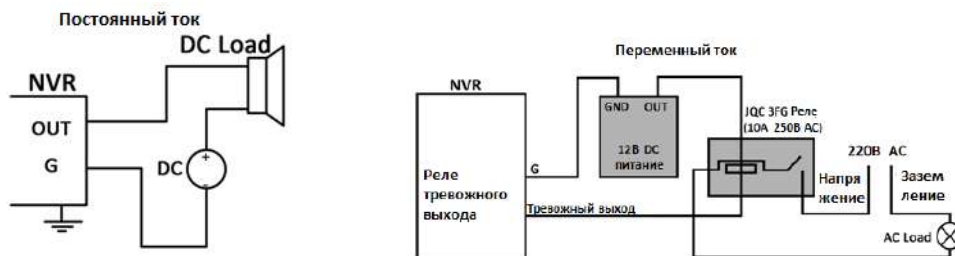
Рисунок 2.5 Подключение тревожного выхода
