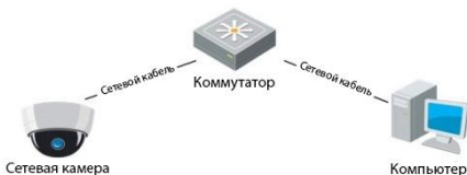
Рисунок 3-2 Соединение через коммутатор или роутер
