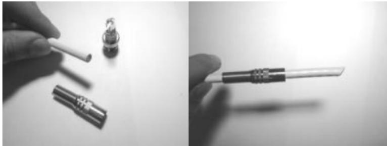
Сделайте надрез изоляции на 10-12 мм от края кабеля. Снимите изоляцию, расправьте оплетку и фольгу
