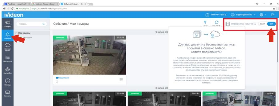
\* Запись коротких видеороликов длительностью 10 с при сработке датчика (5 с до тревоги и 5 с после тревоги). Функция актуальна при использовании бесплатного аккаунта iVideon без подключенного облачного хранения видеозаписей
