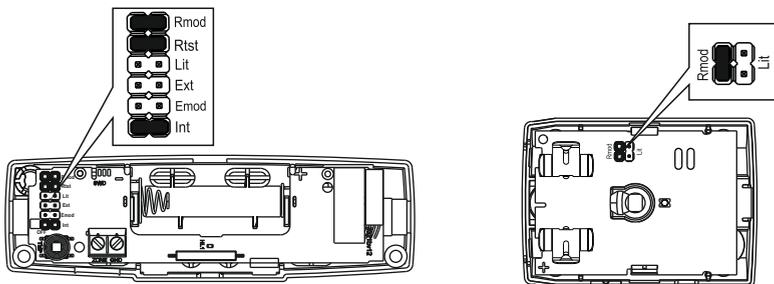
\* В дополнительных датчиках, приобретаемых отдельно от комплекта Security Hub, на вилку **Rmod** установите перемычку.
