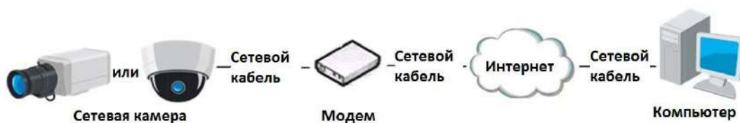
Рисунок 2-12 Доступ к видеокамере с динамическим IP-адресом
