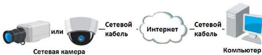
Рисунок 2-11 Доступ напрямую к видеокамере со статическим IP-адресом
