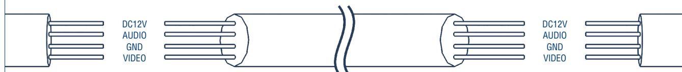
Рис. 3.3. Неэкранированный кабель (при установке на расстоянии до 50 м)
