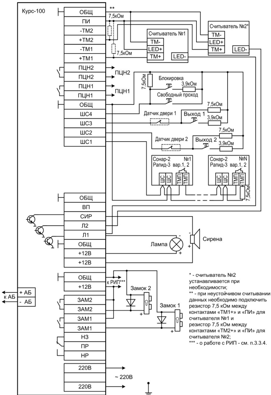
**Рис.8** Схема внешних подключений к контроллеру при конфигурации «1ШС+2ТД», «1ШС+2ТД (Шлюз)»
