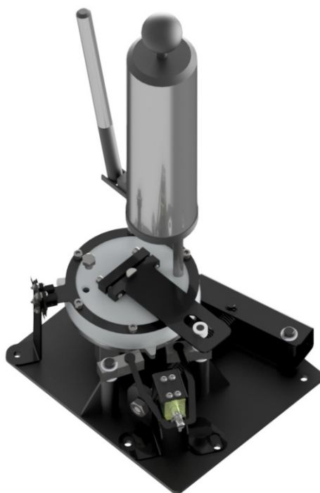
Рисунок 31 – Доливка демпферной жидкости
