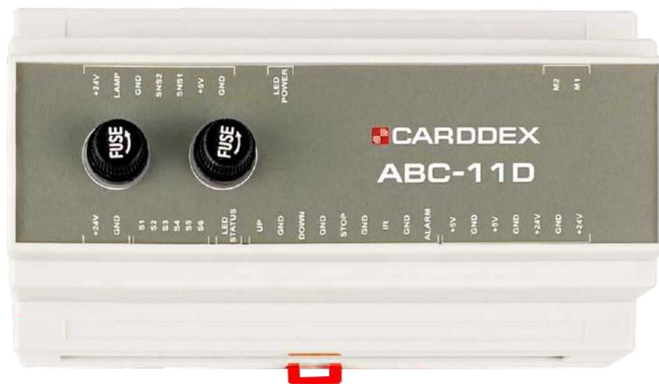
Рисунок 6.5.1 Электронный блок управления «ABC–11D»
