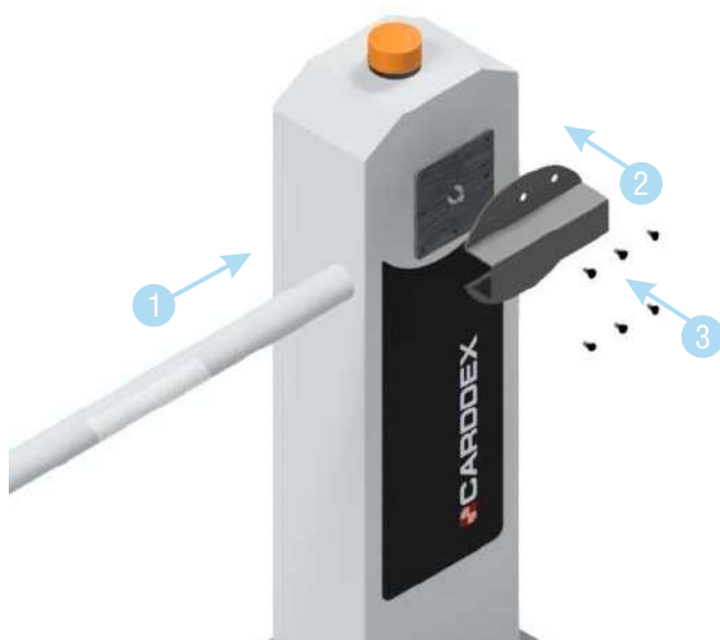
Рисунок 7.4.1 Установка стрелы на шлагбаум
