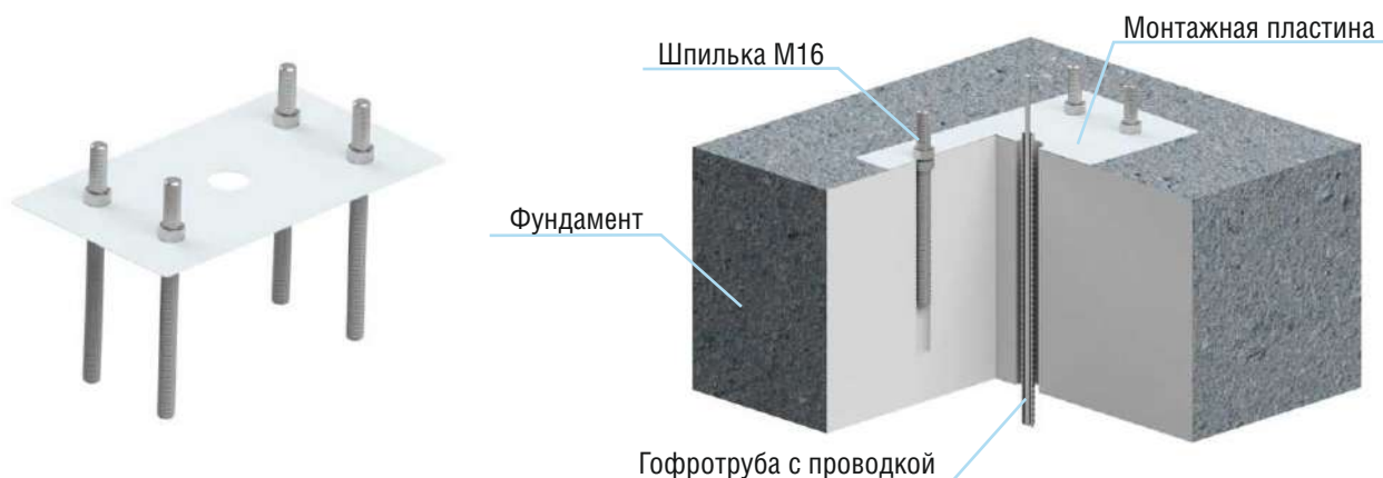
Рисунок 7.2.1 Устройство фундамента с монтажным комплектом
