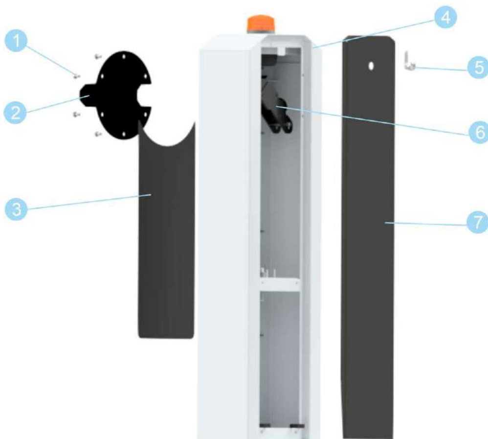
Рисунок 6.1.1 Внешний вид и состав корпуса шлагбаума
