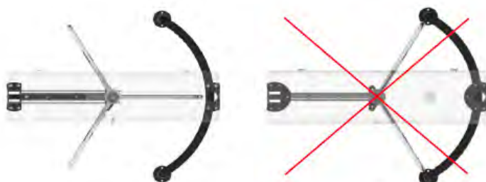
Правильно установленный ротор
