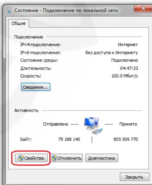
В открывшемся окне свойств сетевого подключения необходимо выбрать пункт **[Протокол Интернета версия 4 (TCP/IPv4)]** и нажать кнопку **[Свойства]**
