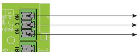
**Релейный выход** (Н.О. контакты) для сигнализации вращения по часовой или против часовой стрелки.
