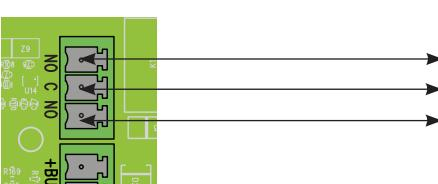
**Релейный выход (Н.О. контакты)** для сигнализации вращения по часовой или против часовой стрелки.
