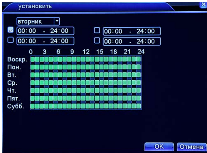
Рис 4.6 Установка периода наблюдения
