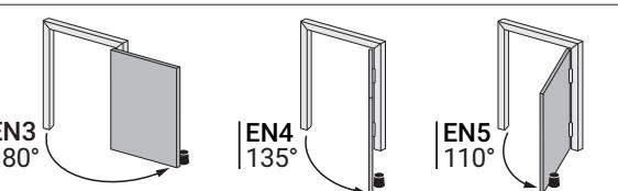
Углы открывания дверного полотна при различной установке согласно шаблону
