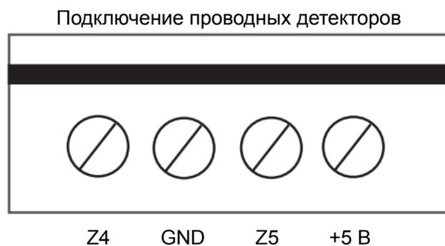
Подключение: Клемма зоны Z4 (или Z5) и клемма GND используются для подключения тревожного выхода детектора. Если выход тревоги детектора нормально замкнутый, установите соответствующий переключатель в нужное положение. При срабатывании детектора ретранслятор передаст сигнал срабатывания, который можно зарегистрировать в беспроводной системе сигнализации (совместимой по кодировке) в любую беспроводную зону.
