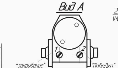
2 отв. под винт М6 или шуруп  $\Phi$  6 мм
