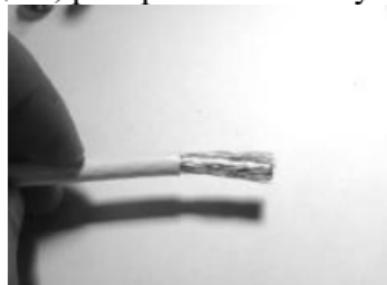
Для удобства монтажа скрутите оплетку. Излишки фольги и оплетки, выступающие из-под разъема можно срезать ножом. Страйтесь не повредить при этом изоляцию. Центральная жила должна выступать из разъема на расстояние от 2 до 5 мм. Отрежьте ее с помощью монтажного инструмента
