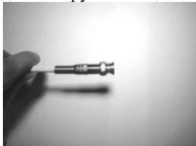
**Важно, чтобы центральная жила не соединялась ни с одним из проводов оплётки – это может привести к короткому замыканию и отсутствию видеосигнала.**
