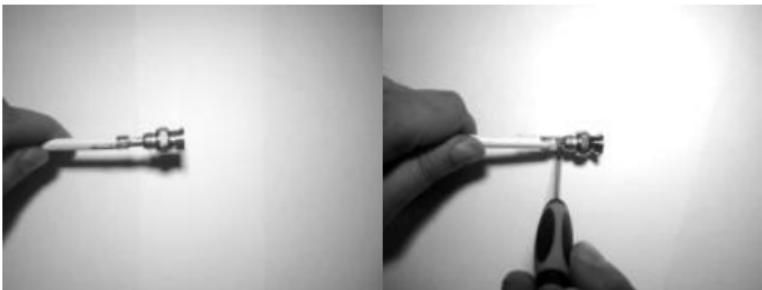
по завершению обожмите монтажным инструментом кабель и оплетку на разъеме. Далее для завершения монтажа необходимо закрутить защитный колпачок
