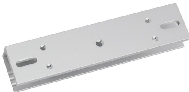
Кронштейн U типа выполнен из алюминия и предназначен для крепления якоря электромагнитного замка на стеклянной двери 10–15 мм.
