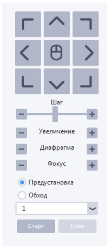
С помощью набора кнопок со стрелками можно поворачивать камеру в соответствующем направлении, шаг поворота при этом регулируется ползунком «Шаг».
