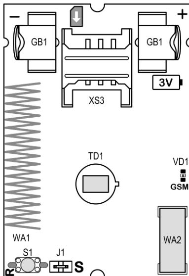
На плате сигнализатора (см. рис.2) установлены: держатель SIM карты (XS3), держатели батареи питания (GB1), светодиод «GSM» (VD1) для индикации состояния сети, перемычка «S» (J1) и кнопка «R» (S1), используемые при настройке прибора, а также пироэлектрический пассивный инфракрасный датчик TD1 (далее – пироэлемент), антенны GSM и радиоканала (WA2 и WA1) и встроенный звуковой оповещатель (на рисунке не указан, расположен на обратной стороне платы).
