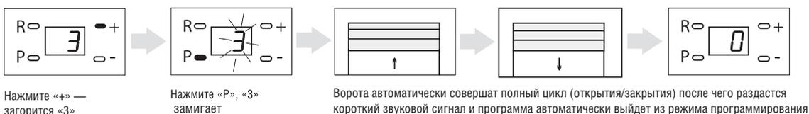
После автоматической настройки усилия раздастся короткий звуковой сигнал и программа автоматически выйдет из режима программирования.
