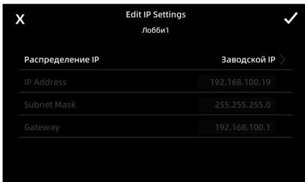
**Вручную:** Установите IP-адрес для вызывной панели вручную..
