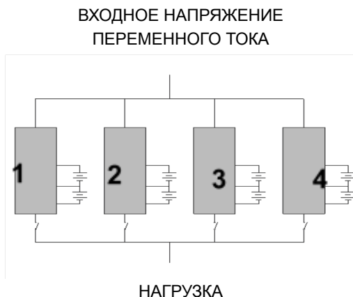
Рисунок 24 — Схема подключения изделий в систему параллельного резервирования.
