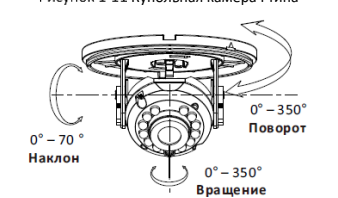
Рисунок 1-12 Настройка угла наблюдения камеры
