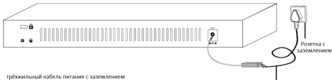
Рисунок 2.9 Заземление с использованием трехжильного кабеля питания
