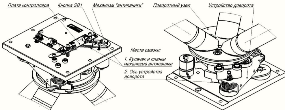
Рис.8 Расположение узлов и деталей трения. Места смазки
