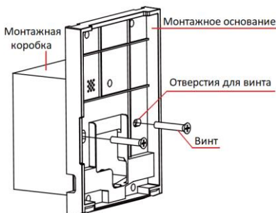
Рисунок 4-1 Установка монтажного основания
