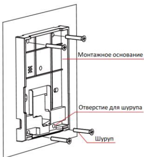
Рисунок 4-4 Установка монтажного основания
