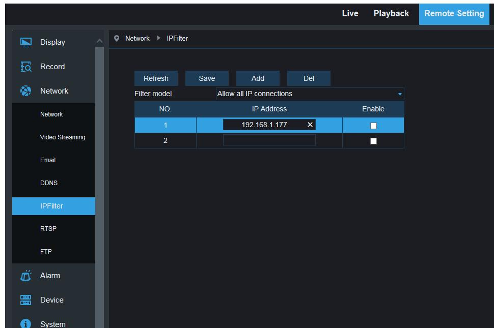
**Filtering mode:** Доступны три режима (Разрешить все IP-соединения, Разрешить все заданные IP-подключения, Запретить заданные IP-соединение).
