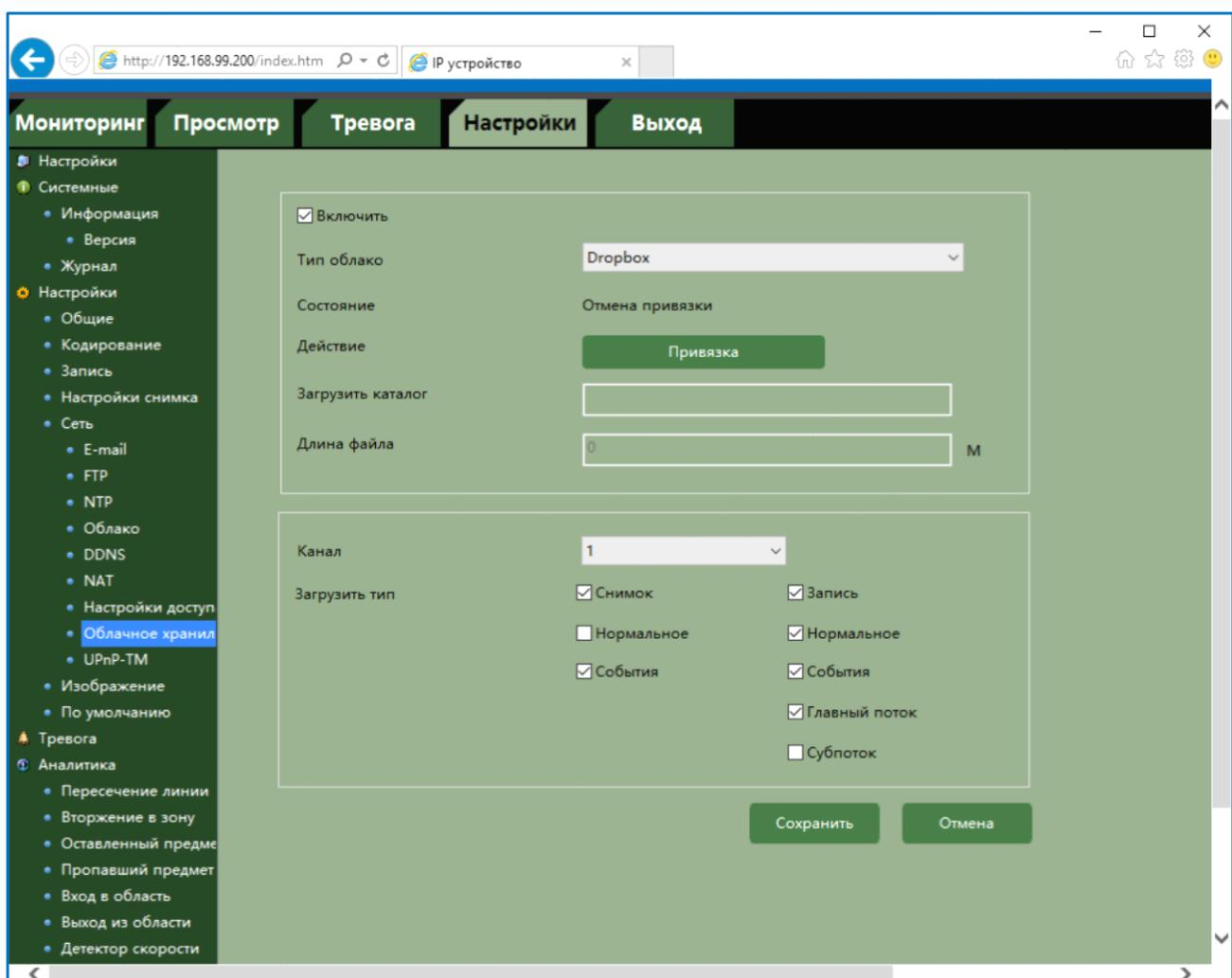
Для синхронизации с dropbox поставьте галочку **Включить**, выберите Тип облака – Dropbox и нажмите кнопку **Привязка**.
