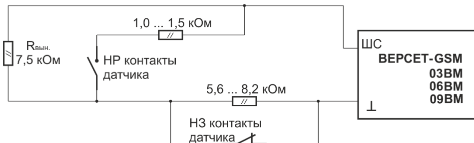
Рис.7. Схема включения технологических датчиков в ШСТ.
