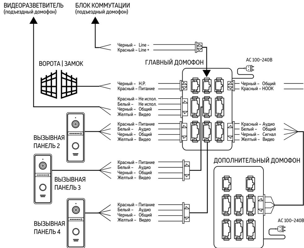
Рис. 12 Схема подключения видеодомофона MAGIC 7C для работы с координатным подъездным домофоном типа Vizit, Cyfral, Eltis, Метакон и тремя вызывными панелями
