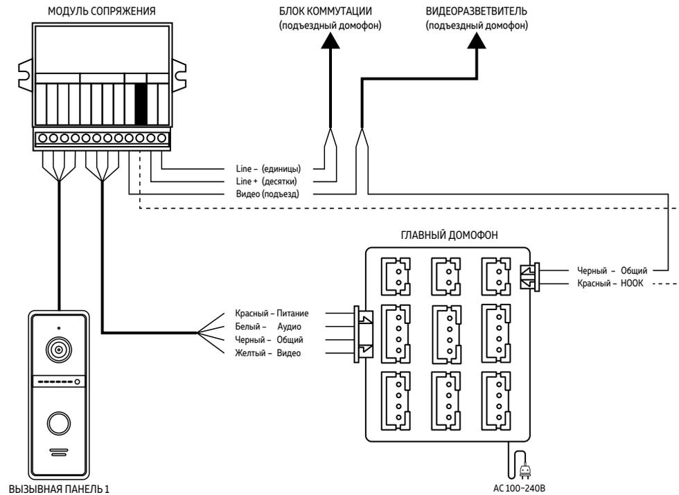
Рис. 13 Схема подключения видеодомофона MAGIC 7С к подъездному домофону через модуль сопряжения
