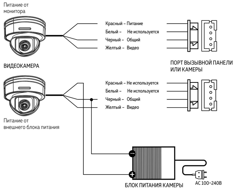
Рис. 14 Схема подключения видеокамеры к видеодомофону MAGIC 7С
