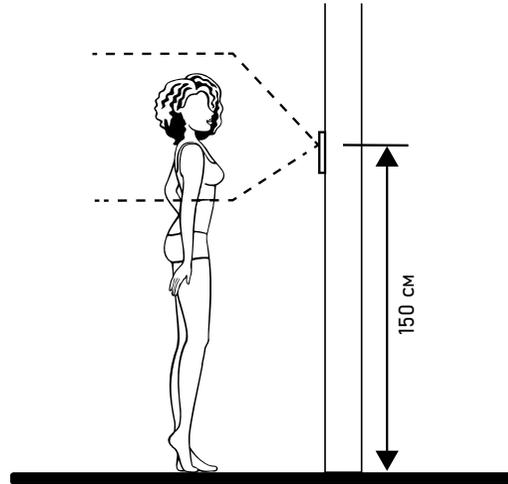
Рис. 4 Рекомендуемая высота установки видеодомофона | вызывной панели
