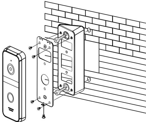
Рис. 7 Установка вызывной панели под углом
