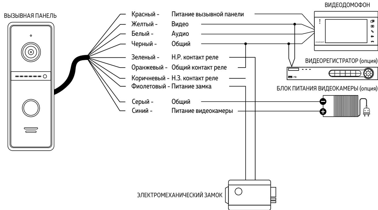
Рис. 16 Схема подключения электромеханического замка к вызывной панели напрямую без блока питания
