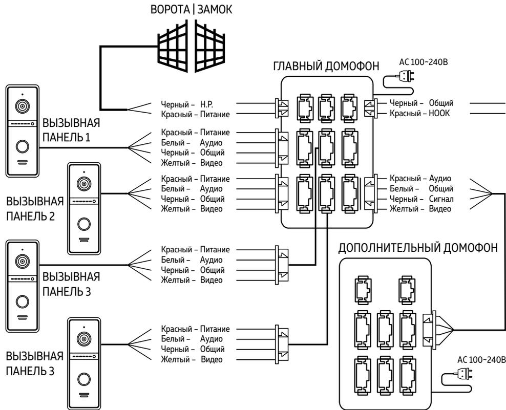
Рис. 11 Схема подключения видеодомофона MAGIC 7C с индивидуальными вызывными панелями
