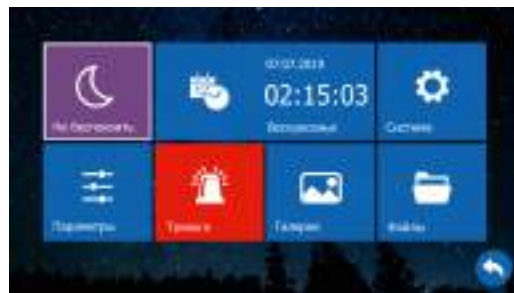
Рис. 17 Активация | деактивация режима "Не беспокоить" из меню видеодомофона
