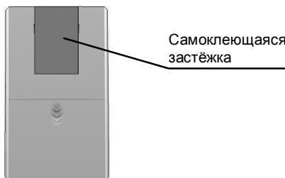
**Рис.13 Место наклеивания застёжки**
