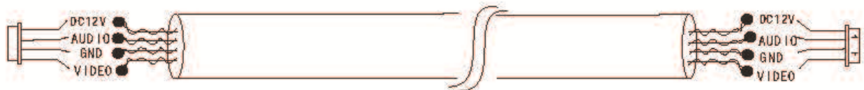
Неэкранированный сетевой кабель (≤ 20м)
