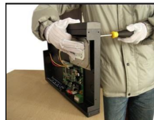
3. закрутите винты HDD
