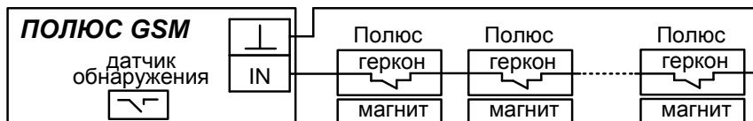
Рис. 6б Схема подключения внешних датчиков. Значение «1» параметра №37, вариант 1
