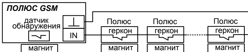
Рис.6а Схема подключения внешних датчиков. Значение «2» параметра №37
