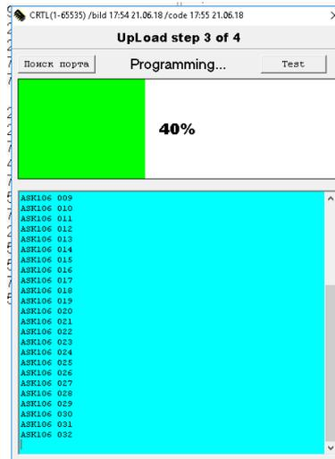
Во время прошивки на считывателе Matrix-III Net будет мигать красный светодиод. После завершения прошивки появится окно:
