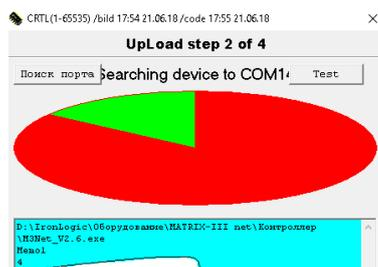
Если питание на считыватель было подано, то нужно снять и снова подать питание. После поиска устройств, подключенных к конвертеру, появится шкала прошивки.
