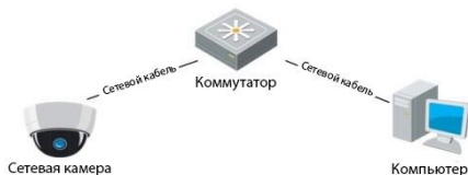
Рисунок 3-2 Соединение через коммутатор или роутер
