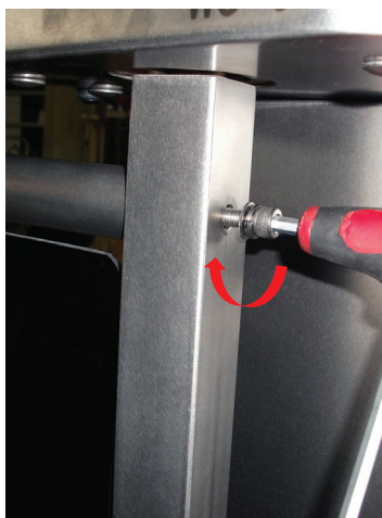
2. Затяните верхний винт
