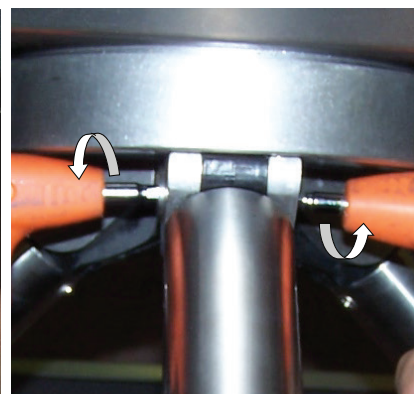
3. Затяните винты (шестигранник 5 мм)
