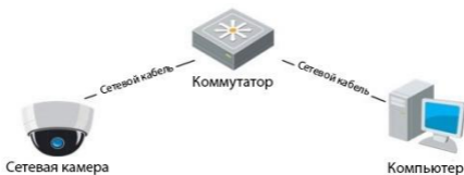
Рисунок 3-2 Соединение через коммутатор или роутер
