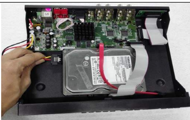
Шаг 4: Установите жёсткий диск, подсоедините кабель питания к материнской плате видеорегистратора
