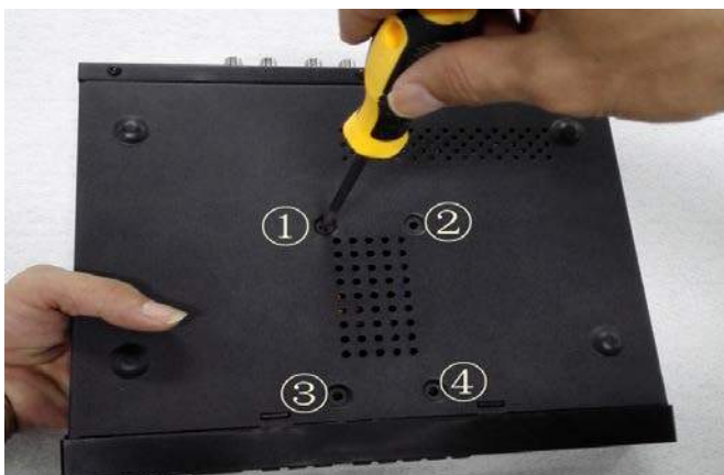
Шаг 6: Зафиксируйте жёсткий диск на держателе при помощи четырёх винтов
