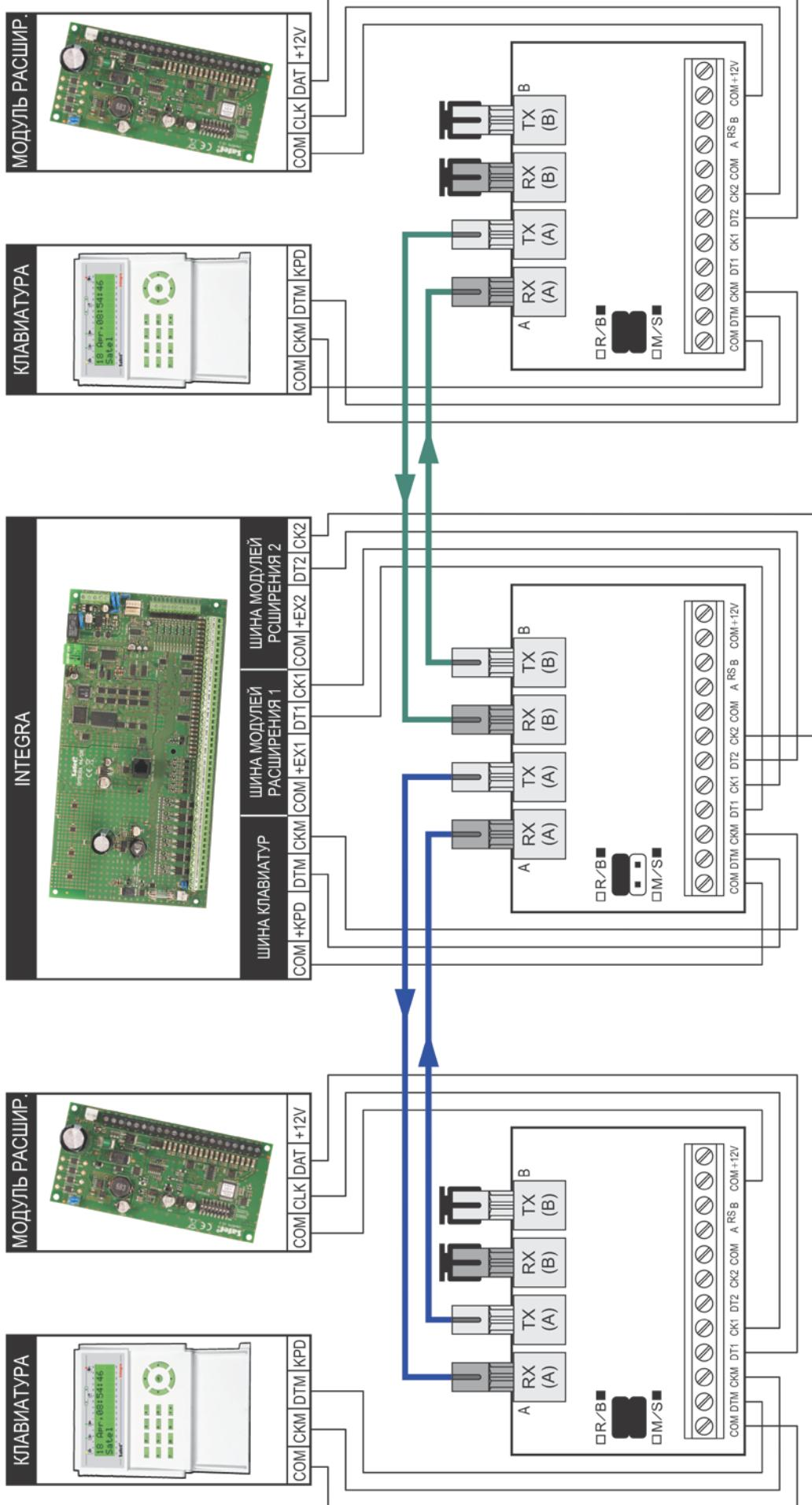
Рис. 5. Пример подключения по топологии типа звезды. Рекомендуется, если существует необходимость прокладки оптоволокон разной длины или в двух разных направлениях от ПКП. Обе пары оптоволокон передают сигналы до / от ПКП, но каждая из них от / до других клавиатур и модулей расширения.
