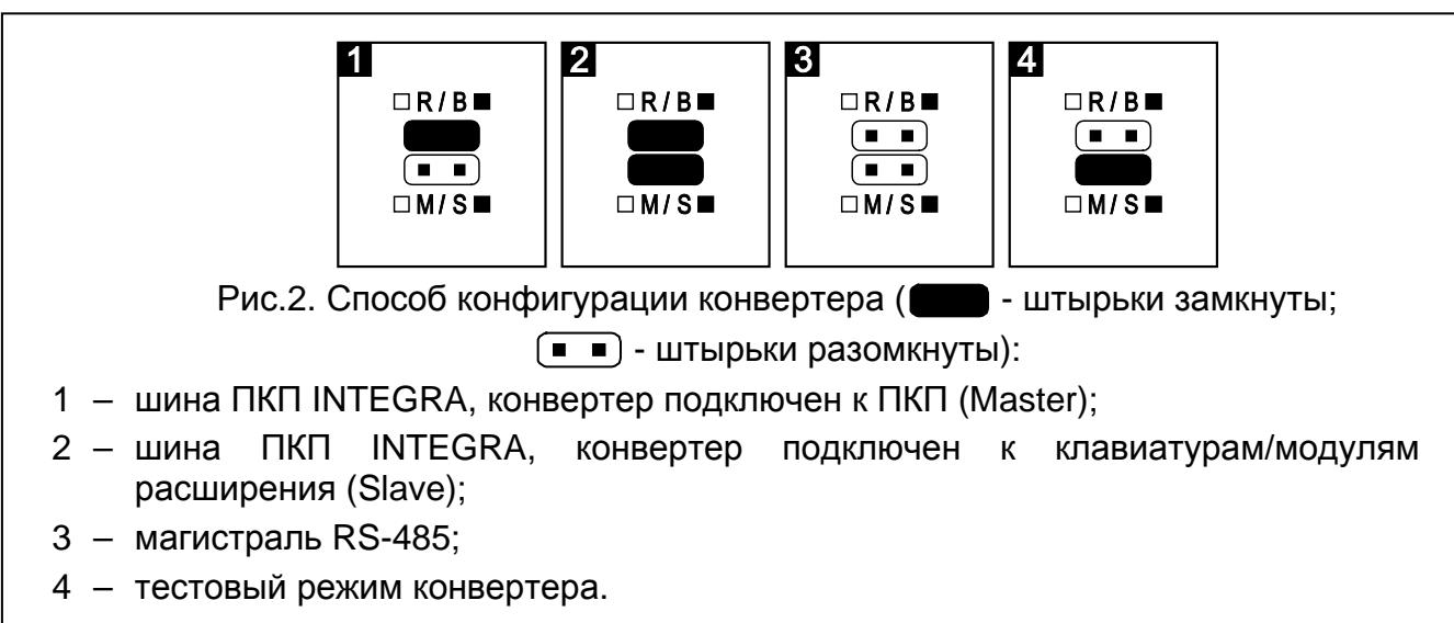
Рис.2. Способ конфигурации конвертера (████ - штырьки замкнуты;
