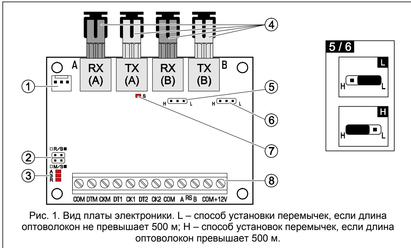
Рис. 1. Вид платы электроники. L – способ установки перемычек, если длина оптоволокон не превышает 500 м; H – способ установок перемычек, если длина оптоволокон превышает 500 м.
