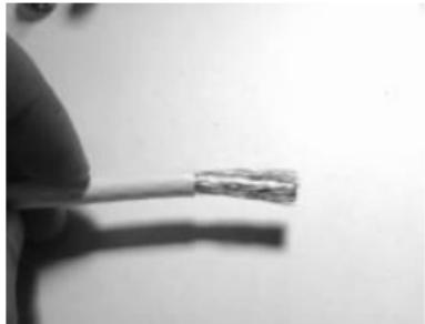
Для удобства монтажа скрутите оплетку. Излишки фольги и оплетки, выступающие из-под разъема можно срезать ножом. Страйтесь не повредить при этом изоляцию. Центральная жила должна выступать из разъема на расстояние от 2 до 5 мм. Отрежьте ее с помощью монтажного инструмента.
