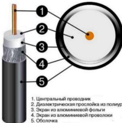
Не забудьте перед началом разделки надеть на кабель защитный колпачок от BNC-разъема.
