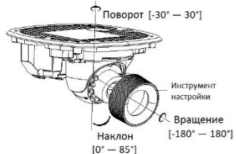
Рисунок 1-25 Настройка угла наблюдения камеры
