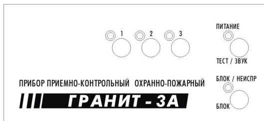
Рисунок 4.2 – Панель управления ППКОП «Гранит-3А»
