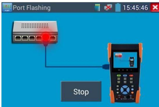
Рис.3.3.13-2 Определитель портов
