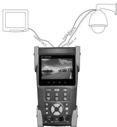
Рис 3.2.2-1 Подключение тестера к аналоговой камере.
