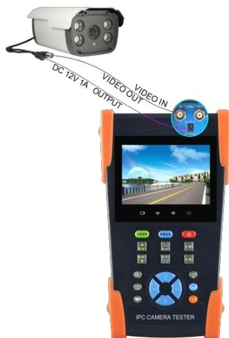
Для включения питания нажмите кнопку-переключатель на сенсорном экране. Специальный кабель с двумя штеккерами питания тонким концом подключите к тестеру, а более толстым – к камере.
