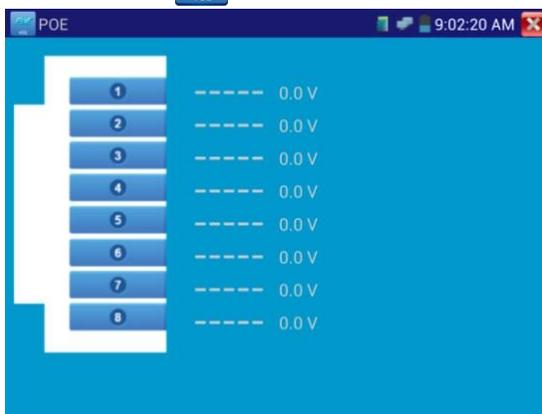
Рис. 3.3.21-1 Напряжение PoE на линиях кабеля витой пары
