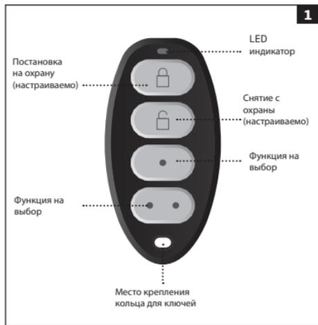
**ПРИМЕЧАНИЕ:** Изображение (выше) отражает стандартную конфигурацию кнопок брелка KeyBoV. Все кнопки брелка настраиваются в соответствии с индивидуальными потребностями с помощью программного обеспечения Eldes Utility.
