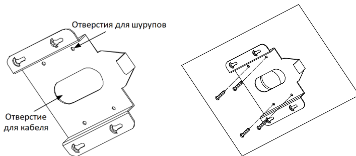
Рисунок 2-40 Крепление монтажного крепления
