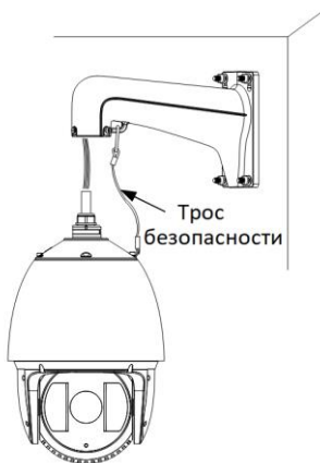
Рисунок 2-19 Установка троса безопасности
