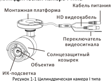
Рисунок 1-1 Цилиндрическая камера I типа
