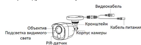
Рисунок 1-5 Цилиндрическая камера IV типа
