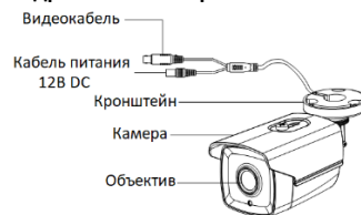
Рисунок 1-4 Цилиндрическая камера III типа
