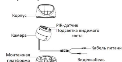
Рисунок 1-17 Камера «шар» III типа
